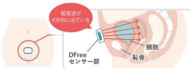
DFreeには超音波センサーが4個搭載されており、反応するセンサーの数に応じて、尿のたまり具合を10段階で表示しています。
